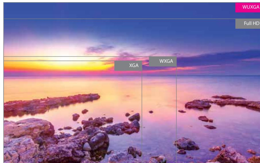
Wenn es auf Details ankommt, bietet die volle WUXGA (1.920 x 1.200) Auflösung 15% mehr Pixel als 1080p und 60% mehr als SXGA+. Dies ermöglicht nicht skalierte Full HD-Videos und zusätzliche Details. Time Code Informationen können gleichzeitig auf dem Bildschirm angezeigt werden, ideal für Soundtrack-Recording und Videobearbeitung, wo genaues Timing entscheidend ist.
